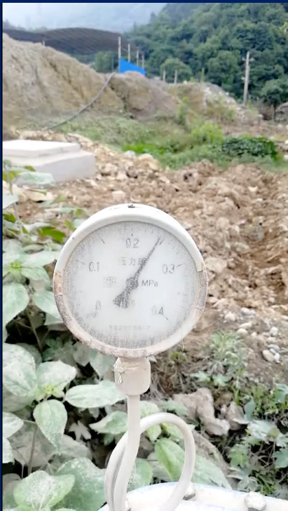
泵站上游4公里处的压力表示数变化
